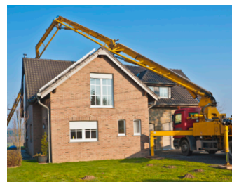
Le système ralentit la machine à l'approche de la zone de danger.
