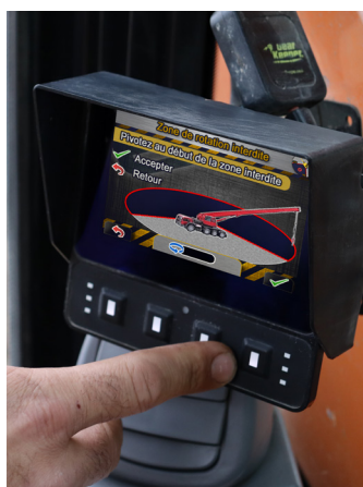
ZONES PROGRAMMABLES Définissez les périmètres de travail selon vos contraintes et vos obstacles.
